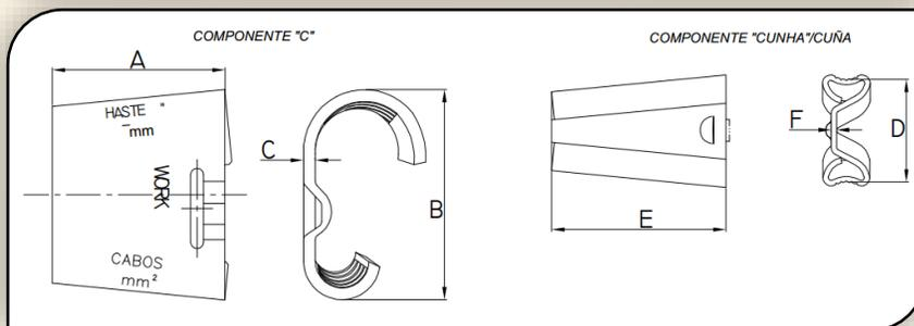
Conector tipo cuña para usos en redes de media y baja tensión Aluminio – Aluminio, y con estribo para conexión.
